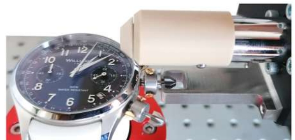
Insertion automatique de l'axe linéaire d'entraînement
