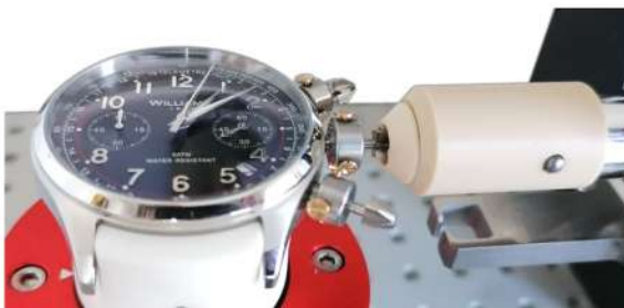
Insertion automatique de l'axe rotatif d'entraînement
