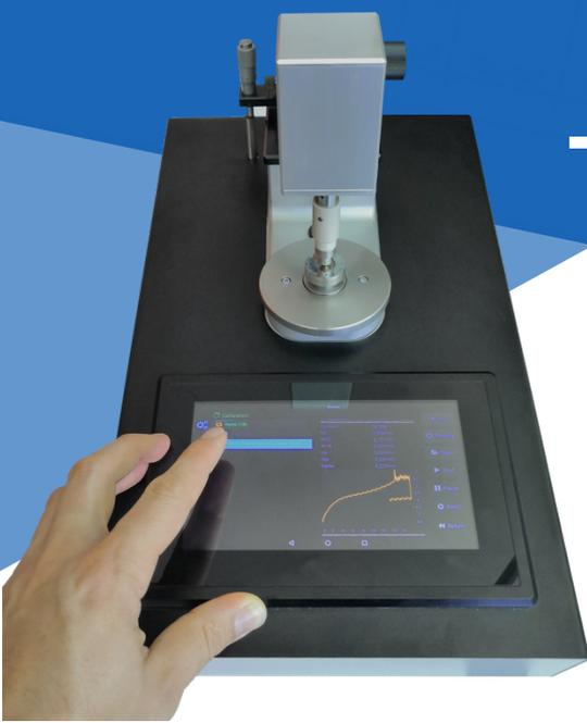
Cet appareil permet d'effectuer tout type de cycle en rotation avec possibilité de mesurer la valeur du couple appliquée.
